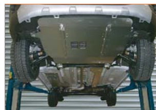
Protections sous moteur et sous caisse
