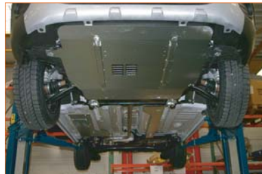
Protections sous moteur et sous caisse
