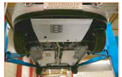
Protections sous moteur et sous caisse
