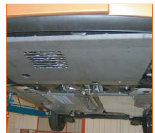
Protections sous moteur et sous caisse
