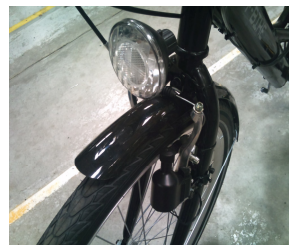
Eclairage par dynamo
