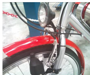
Eclairage par dynamo
